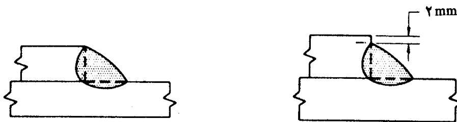
(الف) ضخامت فلز پایه مساوی و یا کمتر از ۷ میلی‌متر
